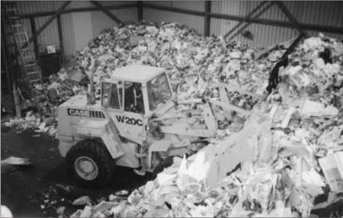
Au centre de tri, une chargeuse amène les matières recyclables au tapis roulant permettant le tri.
