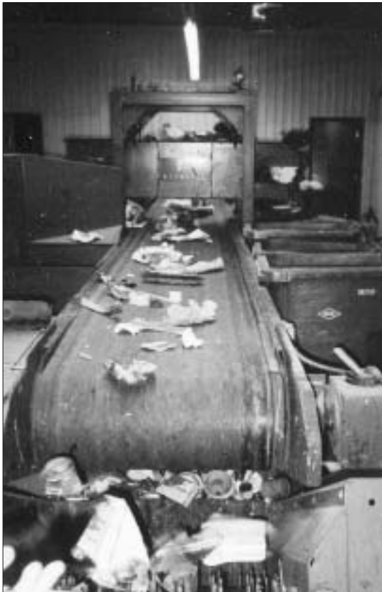
Le tapis roulant amène les matières recyclables jusqu'aux souffleries et aux rouleaux qui séparent les matériaux lourds de ceux plus légers.
