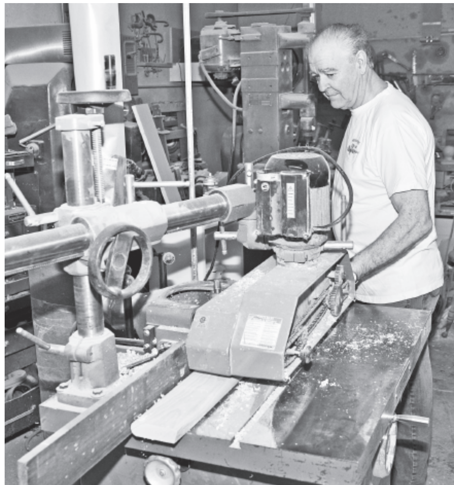
Photo: Michel Fortier Daniel Champagne sur une toupie à arbre fixe à entraînement automatique (automatic wood shaper). Elle n'est pas récente, mais elle est très fiable et peut servir à produire des mouleurs de différentes formes.
